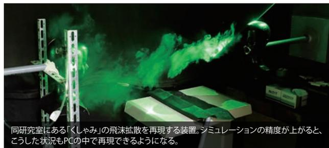
同研究室にある「くしゃみ」の飛沫拡散を再現する装置。シミュレーションの精度が上がると、こうした状況もPCの中で再現できるようになる。
