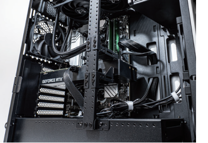
独自のサポート金具によりグラフィックボードを強固に支えている
