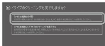
データ保護をするセキュリティチップ「Trusted Platform Module (TPM)」を搭載しているパソコンのリカバリーを行う時に、「すべて削除する」を選択した場合、リカバリーの途中で TPM の初期化に関するメッセージが表示されます。一部のモデルで、TPM を初期化するとリカバリー情報が呼び出せなくなり、以後リカバリーを行ってもドライバーが正しく読み込まれなくなる現象を確認しています。
