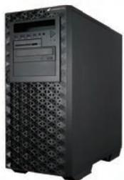
CPU 2基搭載、グラフィックカード最大4基搭載可能。
