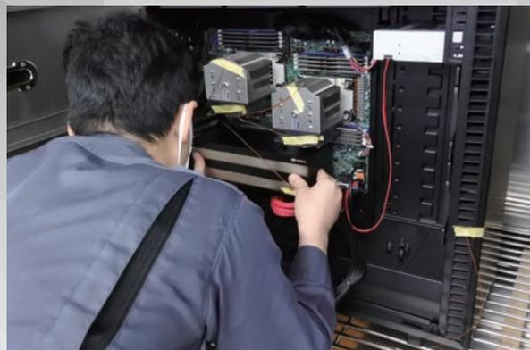
ハイパフォーマンスを要求されるワークステーションは高負荷な処理を短時間で行うため、多くの電力を使用し、大量の熱を発生します。CPUやグラフィックボードが熱暴走を起こすと、処理速度が低下し、最悪の場合は故障の原因にもなります。
